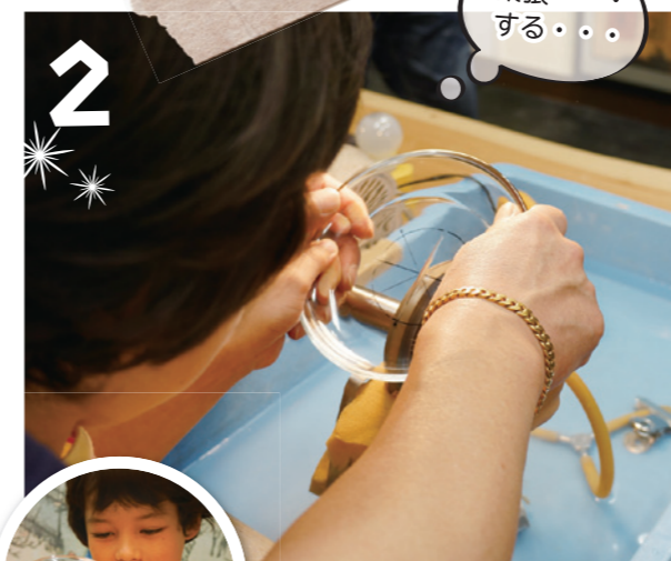
菱形の刃がついた回転工具で3本の線が重なる中心から削る。線に刃を合わせて、押し付ける要領。
