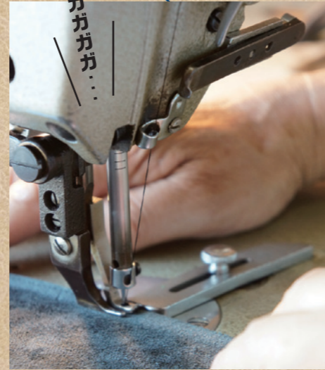
後はひたすらミシンがけ。今回は刺繍をしっかりと目立たせるため、薄いスポンジを貼って補強しているそう。
