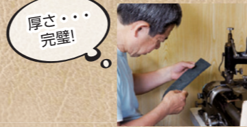
バッグの折り返しなど、何枚も革が重なる部分は革すき機で厚さを調整。
