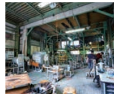
工房内には、ダルマと呼ばれる炉やベンチ、常に1200℃をキープする溶解炉、作品を冷やす徐冷炉(じょれいろう)などの設備がそろ。教室は各クラス定員4名。生徒2人に先生が1人ついて教えてくれる
