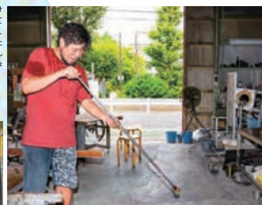
工房内には、ダルマと呼ばれる炉やベンチ、常に1200℃をキープする溶解炉、作品を冷やす徐冷炉(じょれいろう)などの設備がそろ。教室は各クラス定員4名。生徒2人に先生が1人ついて教えてくれる
