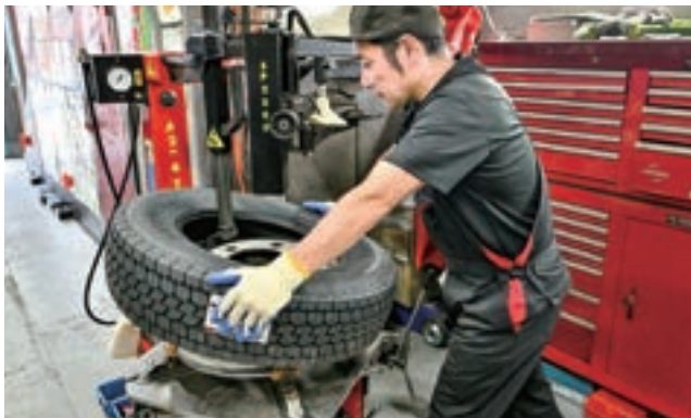
ホイールにタイヤを組み替えた後、1本ずつ車体に装着していく。タイヤ交換の所要時間は1時間ほど
