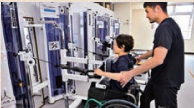
ウェイトトレーニングマシン3種類と、有酸素系運動マシン2種類をラインアップ。体幹ベルトや胸当てが付いているため安全にトレーニングができる。ワイヤーは左右が独立した作りで、左右差や片手のみの使用にも対応
